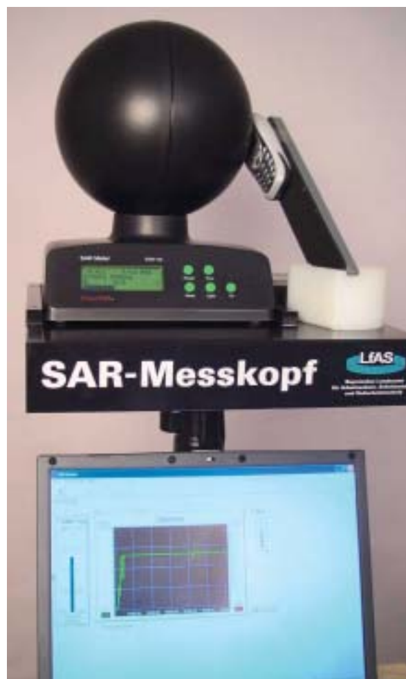
Fig. 1: SAR meter ESM 120
