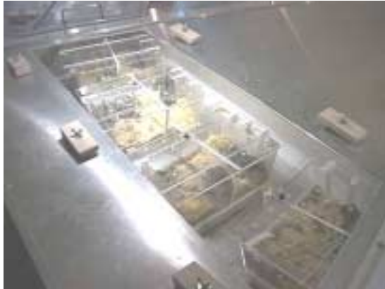
Abb. 3: Teilansicht einer Expositions-kammer mit einem geöffneten Segment. Pro Segment sind 4 Käfige untergebracht.
