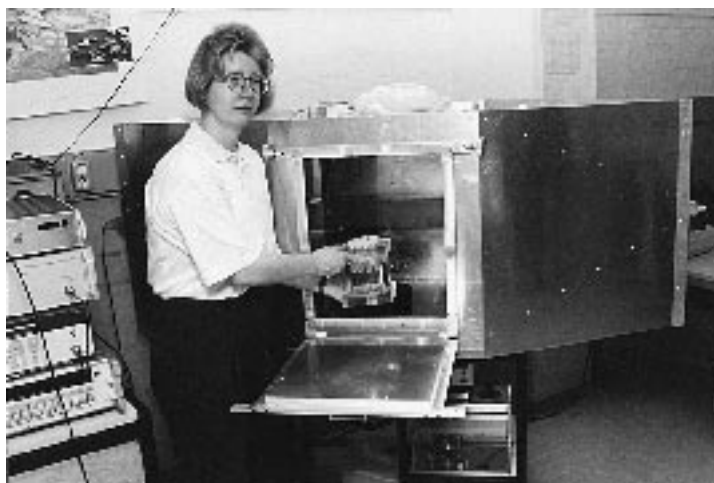
Einbringen des bestückten Probenhalters in die TEM-Zelle; am linken Bildrand sind einige Geräte zur Erzeugung und Aufnahme der hochfrequenten elektromagnetischen Felder sichtbar; die permanente Kontrolle und Meßdatenaufzeichnung der Feldstärken ist durch eine Computersteuerung gewährleistet.
