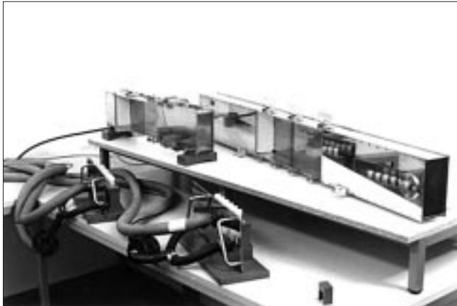
Abb. 1: Geöffneter Hohlleiter (rechts) für Exposition bei 1800 MHz und Kontrollbox (links) mit den dazugehörigen Probenhaltern (unten)
