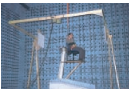
Bild 4: Die Versuchsanordnung im reflexionsarmen Raum
