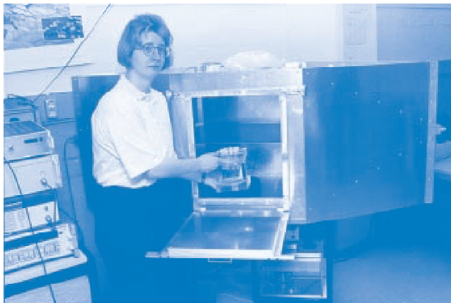
Bild 4: Eingesetzte TEM-Zelle (450 MHz) bei biologischen In-Vitro-Experimenten (TU Braunschweig)
