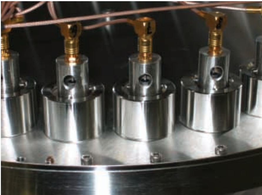
Messaufbau zur Bestimmung des elektrischen Widerstands an der Blut-Hirn-Schranke
