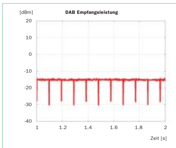
Bild 2: Resultierende Empfangsleistung eines DAB Signals
