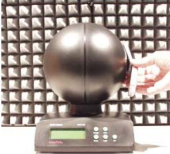
Bild 2: SAR-Messung mit dem ESM-120 (Maschek-Elektronik)
