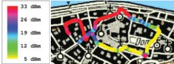
Abb. 5: Örtliche Sendeleistungsverteilung auf der Messstrecke 1 in Passau (Messung 1a)
