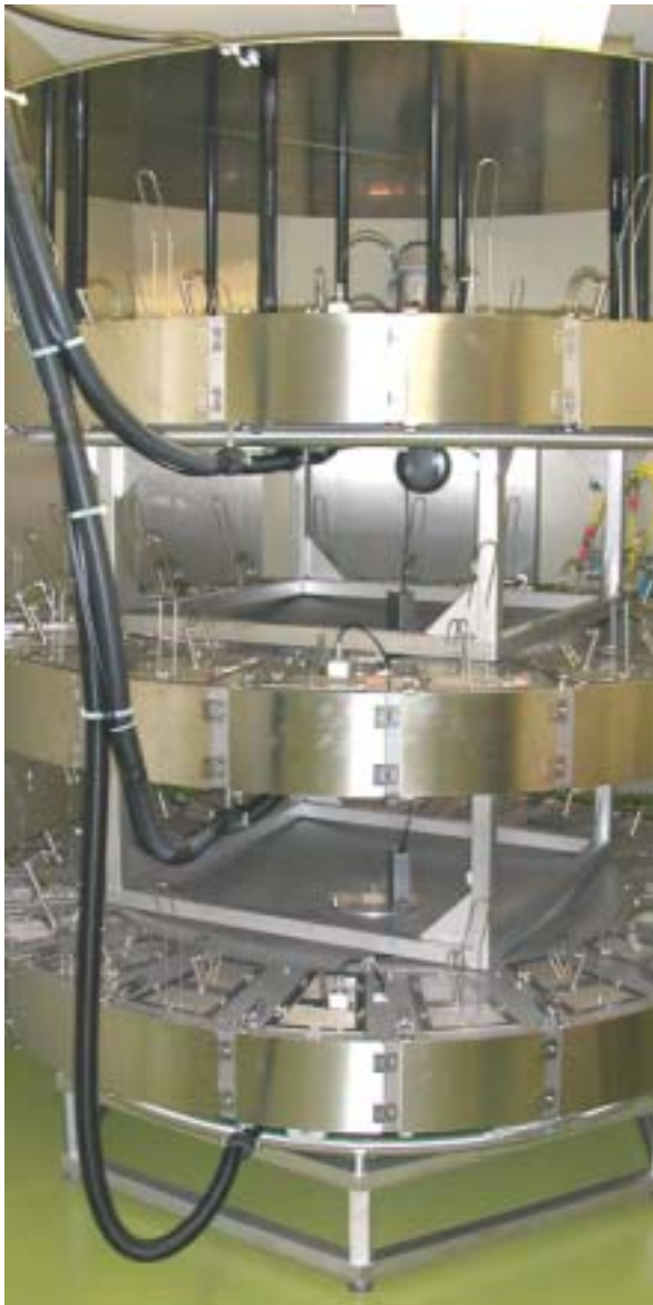
Abb. 1: HF-Expositionsanlage mit 60 Käfigen für freilaufende Ratten
