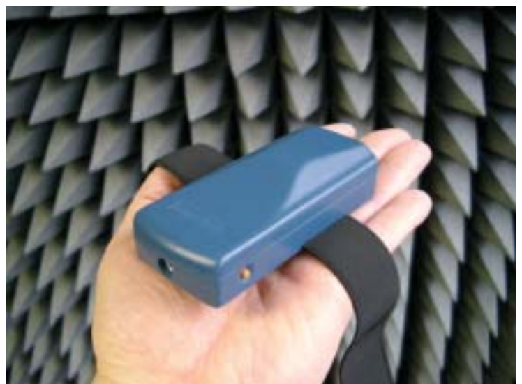
Bild 8: Das Mobilfunkdosimeter ESM-140 mit Halteband. Deutlich zu sehen ist hier der Markierungsknopf für besondere Ereignisse.
