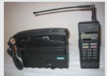
Bild 4: Portables Funktelefon (Siemens) links, erstes Handy (SEL) rechts für das C-Netz
