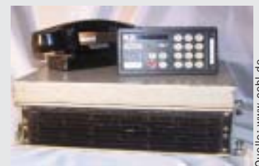
Bild 3: Funkgerät, Bedienteil und Handapparat mit Auflage für das B-Netz (TEKADE)
