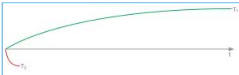
Bild 8: Nach T_1 baut sich die senkrechte Magnetisierung wieder auf; nach T_2 zerfällt die erzeugte waagrechte Magnetisierung wieder.
