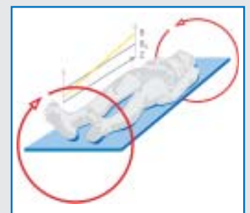
Bild 13: Zwei zusätzliche gegenphasige Spulen geben dem Gleichfeld eine „Steigung“
