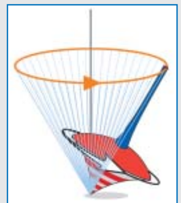
Bild 4: die Präzession eines Kreisel
