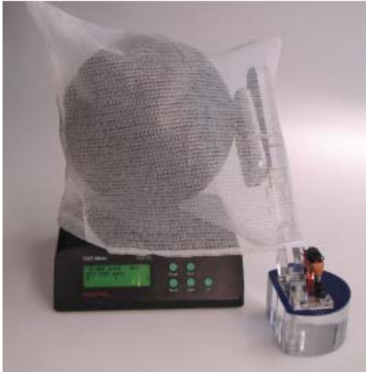
Abbildung 4: Abschirmgewebe zur Simulation einer schlechten Netzsituation
