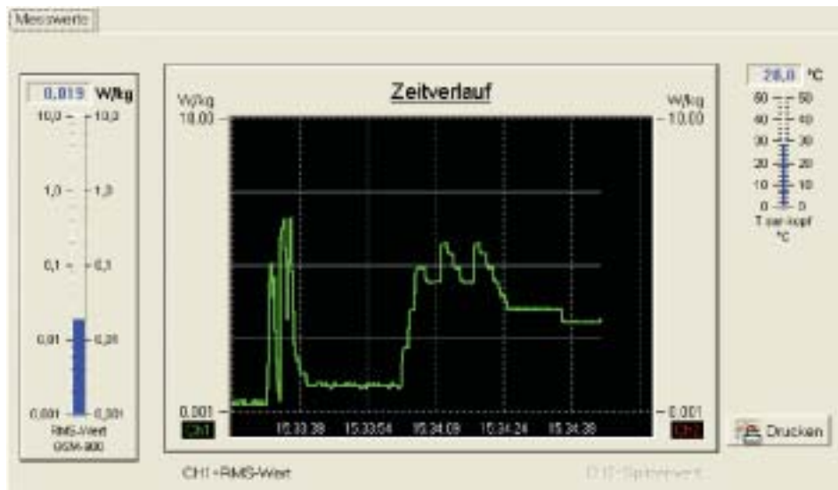
Abbildung 3: SAR Verlauf: Leistungsregelung des Handys bei guter und schlechter Netzqualität
