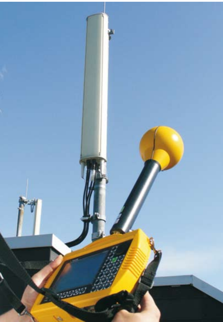
Abb. 1: Feldstärkemessung in unmittelbarer Nähe einer Mobilfunkantenne
