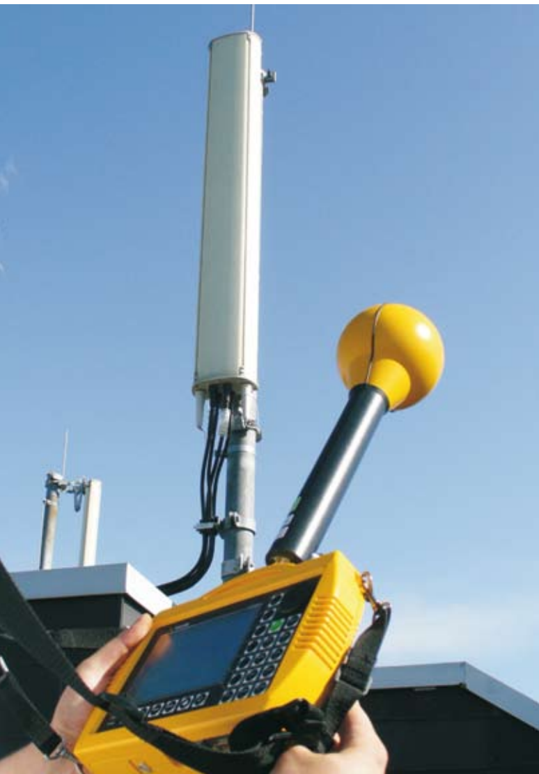
Abb. 1: Feldstärkemessung in unmittelbarer Nähe einer Mobilfunkantenne
