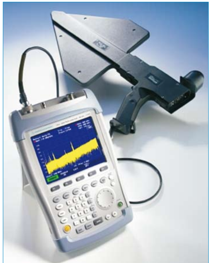
Abb. 5: Frequenzselektive Messtechnik mit Spektrumanalysator und Messantenne (Rohde & Schwarz)
