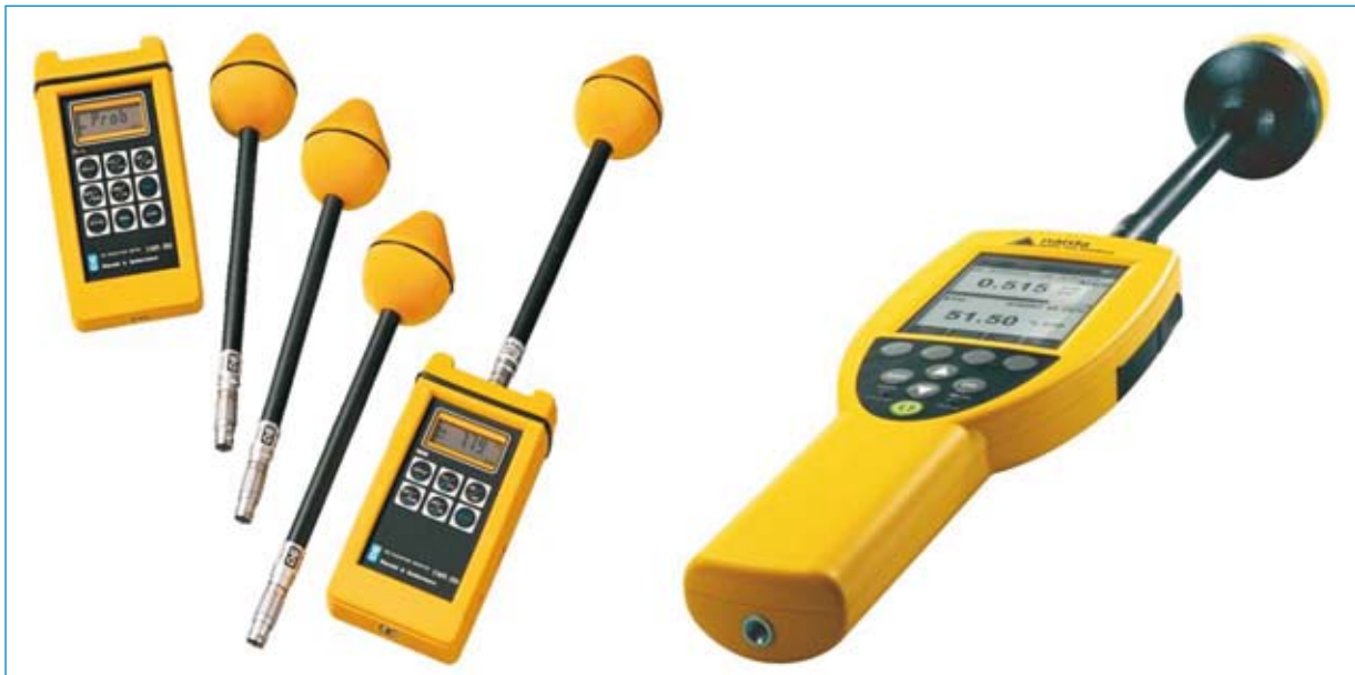
Abb. 4: Breitbandmessgeräte für Hochfrequenzfelder (Narda STS)
