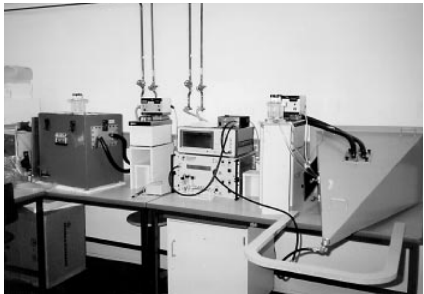
Mit Hilfe eines Simulators (hier die Anlage der Technischen Universität Berlin) lassen sich Wachstumseinflüsse auf Zellkulturen durch Magnetfeldbestrahlung unter Ausschaltung der sonst üblichen thermischen Schwankungen untersuchen.
