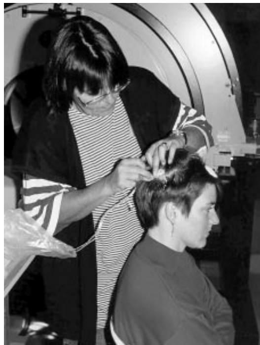
Wissenschaftler untersuchen, ob EM-Felder Auswirkungen auf die elektrische Aktivität des Gehirns (EEG) haben. Die Messung der Gehirnströme erfolgt mittels Elektroden, die am Hinterkopf des Probanden angeklebt werden. (Foto: CETECOM, August '93)
