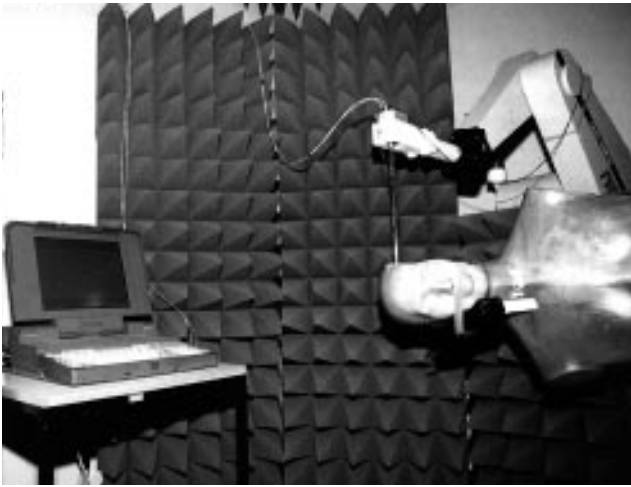
Messung der spezifischen Absorptionsrate (SAR) am Phantomkopf. (Foto: ETH Zürich/ Prof. Kuster)
