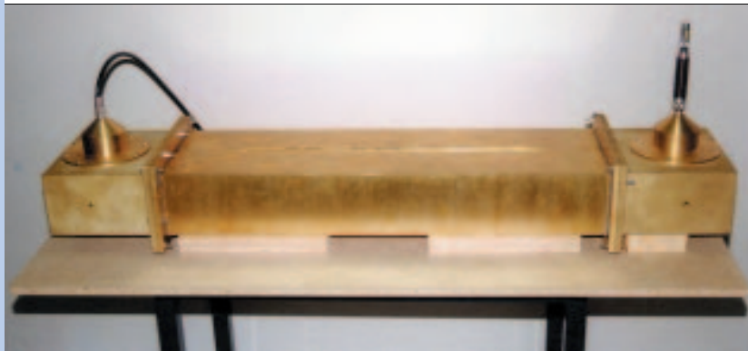
Ein Großteil der biologischen Versuche der FGF wurden in dem eigens entwickelten Hohlleiter durchgeführt.
