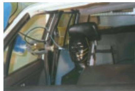
Bild 4: Anordnung zur Bestimmung der SAR-Werte innerhalb eines flüssigkeitsgefüllten Phantoms auf der Beifahrerposition eines VW Golf.
