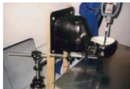
Bild 2: Meßaufbau zur Untersuchung des Einflusses in der Nähe befindlicher metallisch leitender Teile auf die SAR-Werte.
