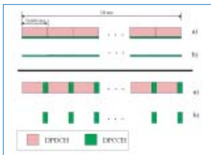
Bild 5: Signalübertragung bei DPCH mit Codemultiplex (oben) und DPCH mit Zeitmultiplex (unten) a) ohne DTX (Normalbetrieb) b) mit DTX (keine Nutzerdaten)
