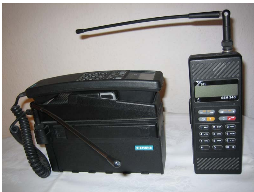
Bild 4: Portables Funktelefon (Siemens) links, erstes Handy (SEL) rechts für das C-Netz
