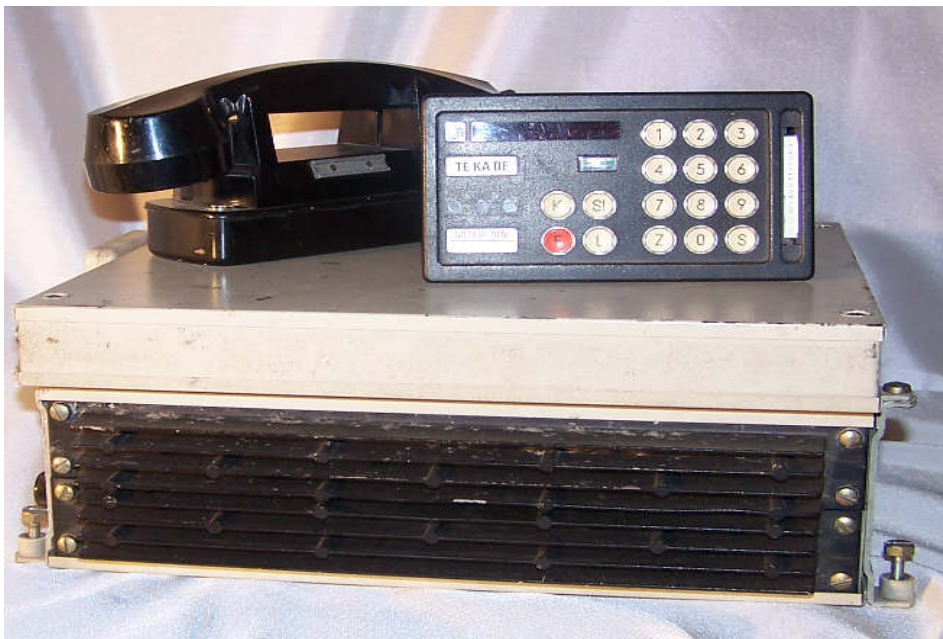
Bild 3: Funkgerät, Bediengerät und Handapparat mit Auflage für das B-Netz (TEKADE)
