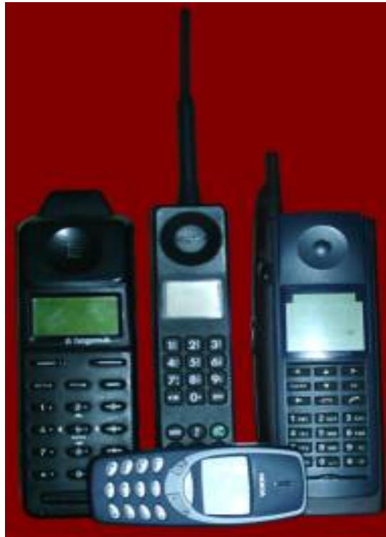
Bild 5: D-Netz-Handys aus der Anfangszeit (Hagenuk, Motorola, Dancal) im Vergleich zu einem Handy von heute (Nokia);
